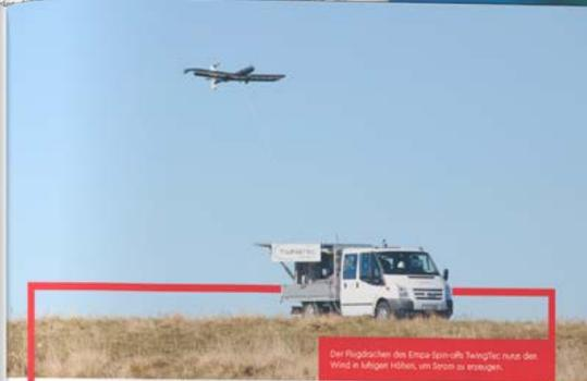
Der Flugdrachen des Empa-Spezialists TwinTec nutzt den Wind in fälligen Höhen, um Strom zu erzeugen.
